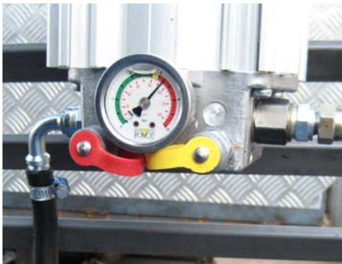
Flera tillverkare av by-pass-filter har valt att montera en manometer för att indikera filterbyte.
